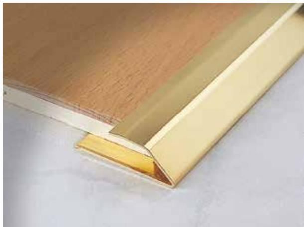
Profilo terminale ideato per rifinire e contenere pavimenti flottanti in legno, raccordandoli ad altre superfici adiacenti di livello inferiore o nella posa di parquet su pavimenti preesistenti. Funge anche da giunto di dilatazione. Da fissare al supporto con viti e tasselli.
